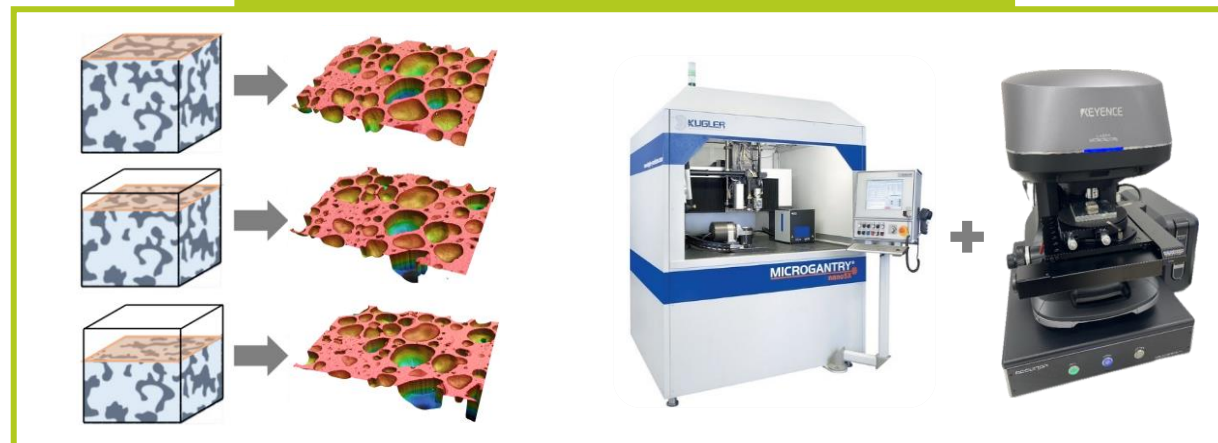
Serienschnittverfahren: Abtragen + Vermessen
