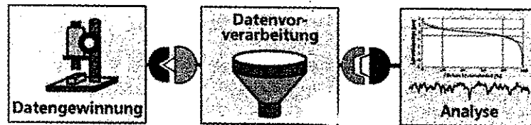
Bild 1: Schritte zur Gewinnung von 3D – Rauheitskennwerten.
