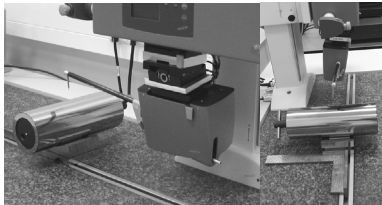
Bild 10: Einsatz des Goniometers am Messgerät: Rollen der Tasterachse um x-Achse bei Radienmessung an Zylindernormal
