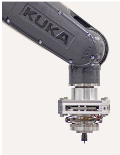
Erweiterter industrieller Roboter mit zusätzlicher Positioniereinheit und Fräser
