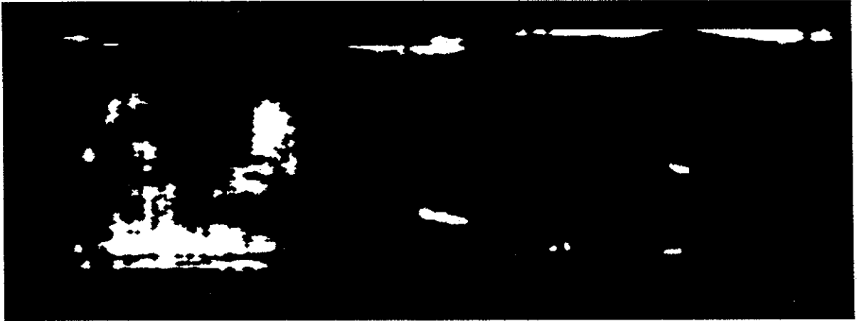
Bild 12: Gemäß Bild 10 generierte Binärmaske m(x,y) zum Extrahieren dunkler Stellen auf der gescannten Zylinderlaufläche.
