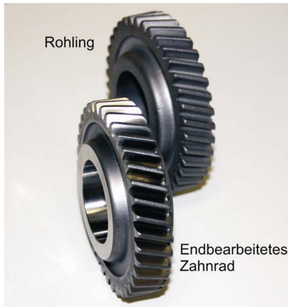
Abbildung 3: Präzisionsgeschmiedetes Zahnrad des SFB 489
