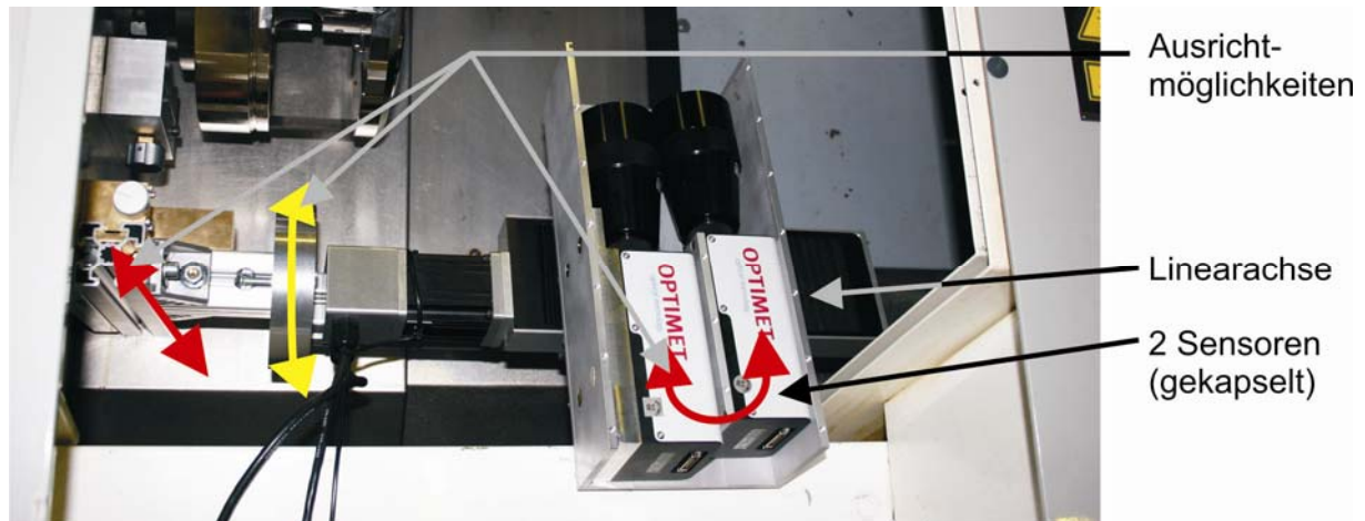
Abbildung 6: Integration der Sensorik in die Werkzeugmaschine (Ritzelwelle)
