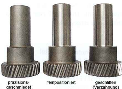
Präzisionsgeschmiedete Ritzelwellen in verschiedenen Stadien der Bearbeitung.
