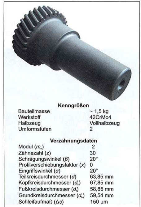
Das Demonstratorteil: präzisionsgeschmiedete Ritzelwelle des SFB 489.
