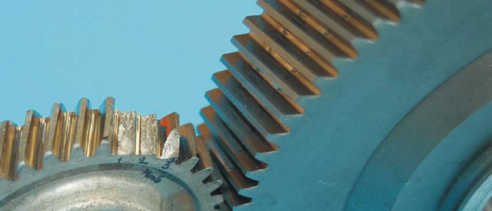
Ausfall eines Getriebes durch Zahnbruch Photo: © IW
